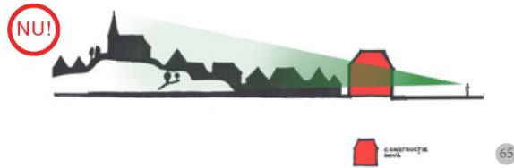
Fig. 65. AȘA NU: Se va evita amplasarea construcțiilor de dimensiuni mari la intrarea în sat, mai ales în conul de vizibilitate al unui monument sau ansamblu important de clădiri. În general, gabaritul clădirilor scade spre marginea satului, iar clădirile noi trebuie să țină cont de acest lucru.
