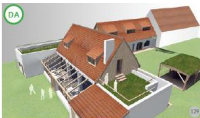
Fig.125. AȘA DA: Construcție nouă. Forma acoperișului respectă specificul local al zonelor cu pantă între 50-55%.
