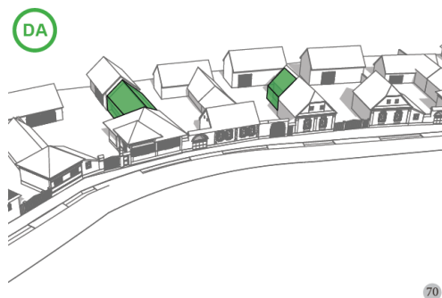
Fig.70. AȘA DA: Spațiul liber dintre grajd și sură poate fi utilizat ca spațiu constructibil. Se recomandă atenție mărită pentru problemele legate de incendiu, legătura nouă convertind întregul ansamblu într-un volum unic.
