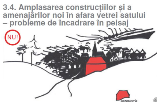
Fig.62. ASA NU: Se interzice amplasarea unor clădiri noi în vizorul primei imagini asupra satului, indiferent dacă se merge pe un drum de țară, printre dealuri, sau pe o șosea de mare trafic.
